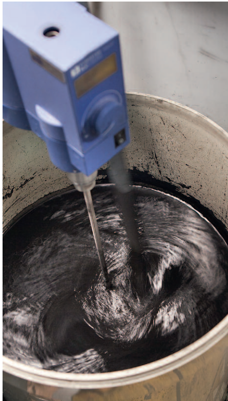
Pulveraktivkohle (hier in einem Pilotversuch) eliminiert Mikroverunreinigungen im Abwasser. Bild: Andri Bryner, Eawag
