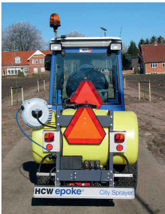
Ein Vorteil beim Ausbringen der Sole ist, dass sie nicht wie Trockensalz von Böen verweht wird: links der Epoke-Flüssigstreuers, rechts der IceFighter.
