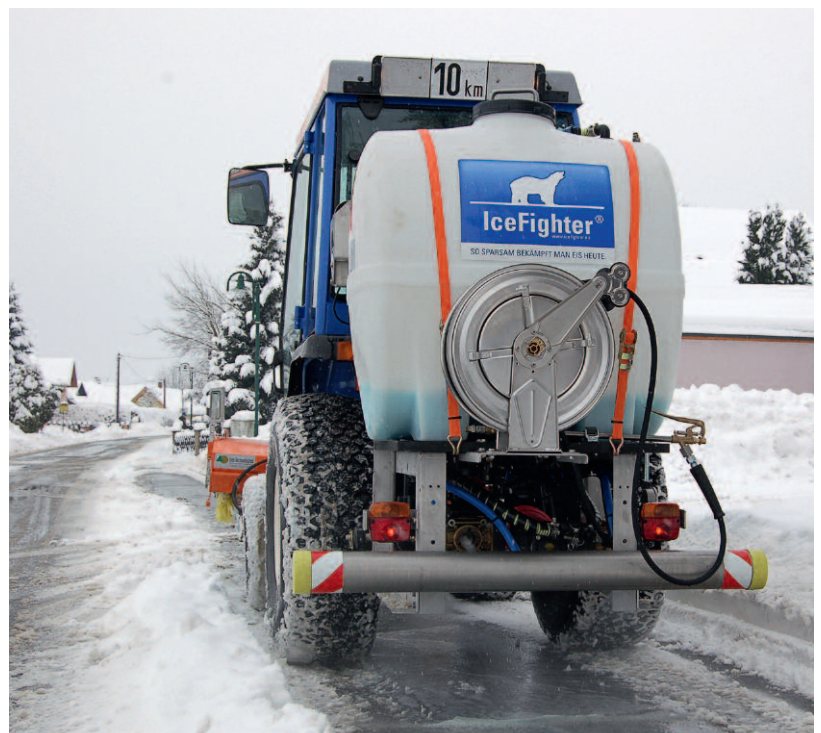
Ein Vorteil beim Ausbringen der Sole ist, dass sie nicht wie Trockensalz von Böen verweht wird: links der Epoke-Flüssigstreuers, rechts der IceFighter.
